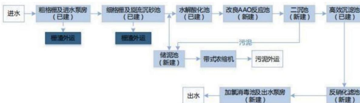
图 4-2 污水处理厂工艺流程图
